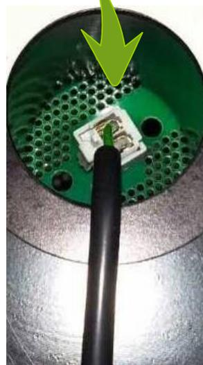
通向反式线圈的引线
